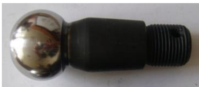
Рисунок 2. Шаровой палец после полировки сферической поверхности пальца.
